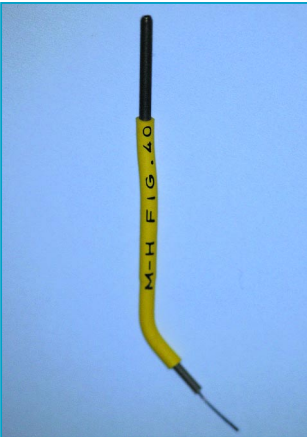
Eine Spezialelektrode lässt die individuelle Verlängerung des „Schneide“drahts zu.
